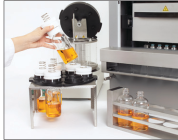
SpeedExtractor에서 Multivapor™로 시료 이동
