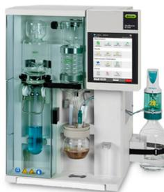
KjelMaster K-375 Dampfdestillation und Titration
