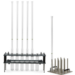
Demanda química de oxígeno (mediante condensadores de reflujo de aire)
