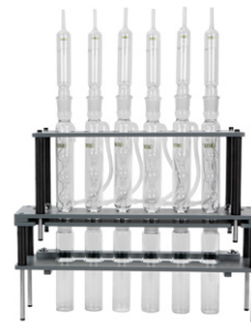
Reflux Setup Reflujo de aire o agua
