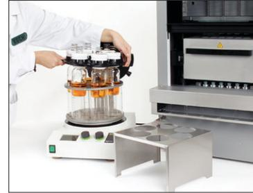
Evaporasi pelarut pada Multivapor™
