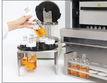
Pindahkan sampel dari SpeedExtractor ke Multivapor™
