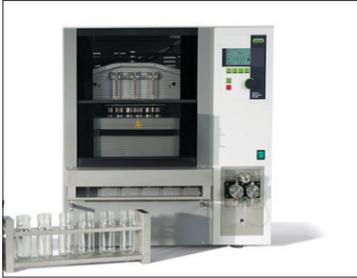
Ekstraksi pelarut bertekanan dengan SpeedExtractor
