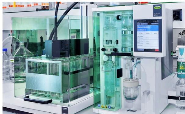
«Lo más destacado del sistema Kjeldahl automatizado de BUCHI es el muestreador de 48 posiciones, que nos permite trabajar de forma ininterrumpida y nos ahorra mucho tiempo».
