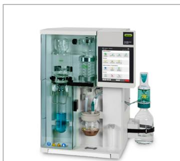
KjelMaster K-375は、ケルダール法によるたんぱく質の定量に最適な装置です。たんぱく質の値は、近赤外分析計で検量線を作成する際の参照値として使用されます。
