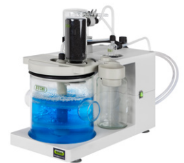
Scrubber K-415 (유해 가스 중화 장비) 중화
