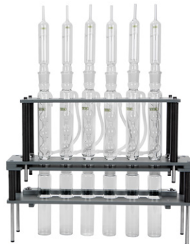
Schwermetalle und Hydroxyprolin (mit Rückflusskühlern, wassergekühlt)
