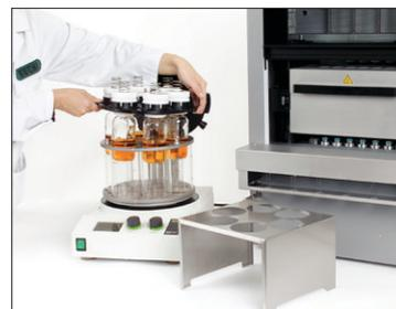
Evaporación de disolventes en Multivapor™
