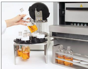
Transferencia de muestras de SpeedExtractor a Multivapor™
