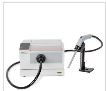
Near Infrared Spectroscopy adalah teknologi pilihan untuk menggantikan penentuan lemak klasik dengan metode penyaringan cepat.
