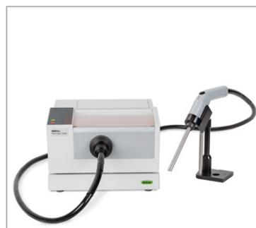
A espectroscopia de infravermelho próximo é a tecnologia preferida para complementar a determinação de gorduras clássica como um método alternativo rápido.
