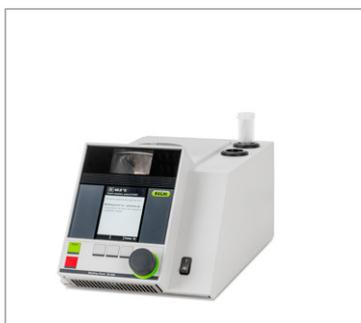
Verifique a pureza de seus compostos com o Ponto de Fusão M-560 ou M-565 para determinação dos pontos de fusão ou ebulição.
