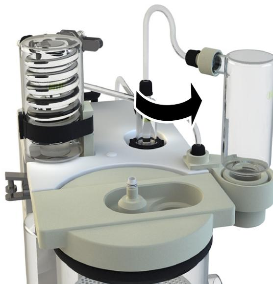
Figura 5.4: Orientamento del recipiente di assorbimento e dei tubi verso il supporto
