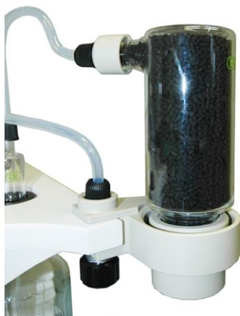
Figura 5.16: Recipiente di assorbimento con carbone attivo e lana di vetro
