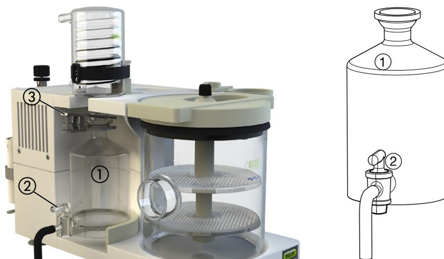
Figura 5.9 Collegamento del set TKN
