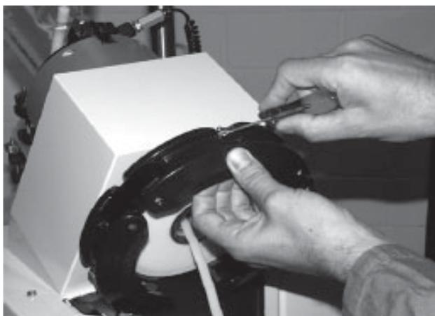
Figura 6.1: Collegamento del collo del pallone chiuso
