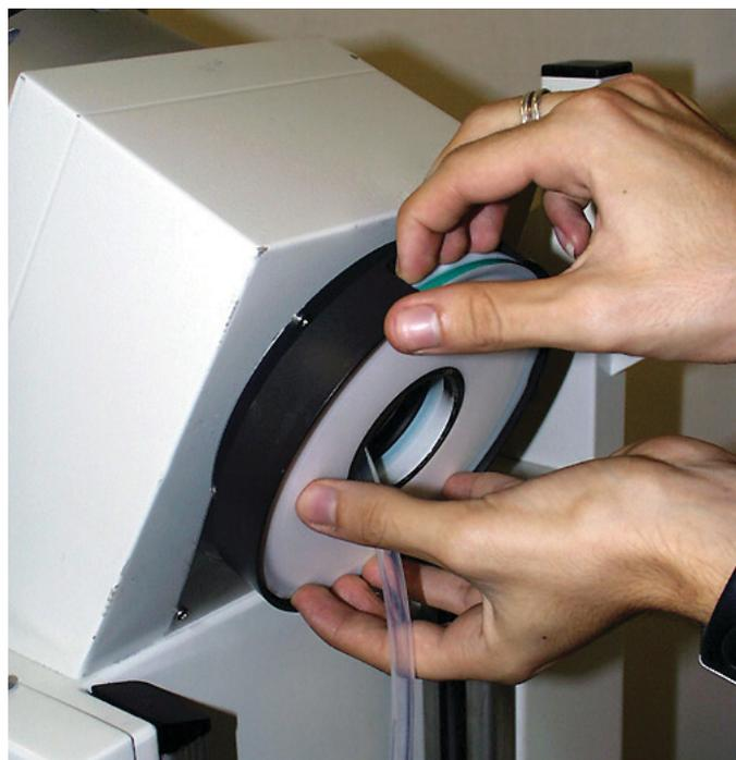
Figura 6.3: Rimuovere la guarnizione del pallone evaporatore
