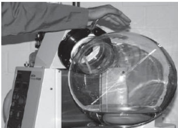
Figura 4.13: Chiudere il collegamento del collo del pallone
