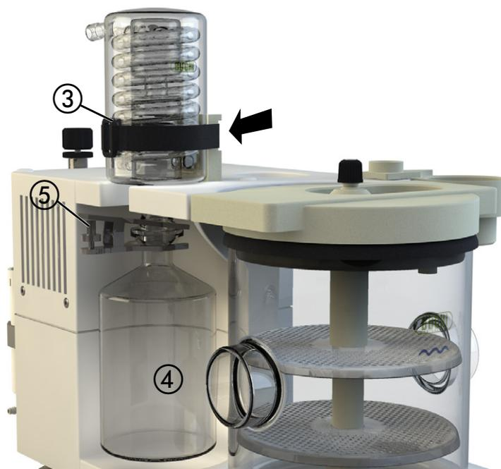
Fig. 5.6: Fijación del refrigerador con la cinta de velcro
