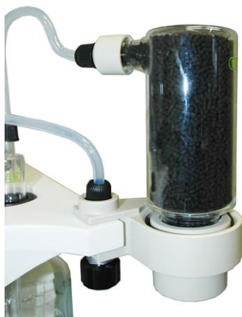
Fig. 5.16: Recipiente de adsorción con carbón vegetal activado y fibra de vidrio
