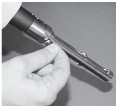
Ajustement de la distance de transmission
