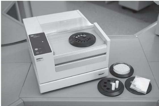
NIRFlex Solids est la configuration idéale pour mesurer des échantillons solides, tels que des poudres, pâtes et pellets en mode réflexion diffuse. La cellule de mesure pour les corps solides permet l'utilisation de différents accessoires pour des récipients spécifiques.
