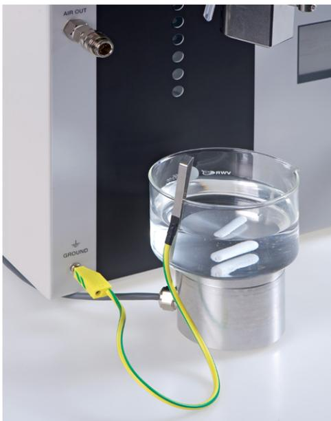
**Abbildung 6-4:** Erdung des offenen Polymerisationsbades
