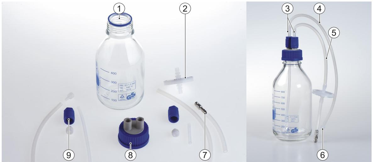
**Abbildung 5-17:** Druckflasche mit HEPA-Filter für steriles Pumpen der Immobilisierungsmischung mittels Luftdruck
