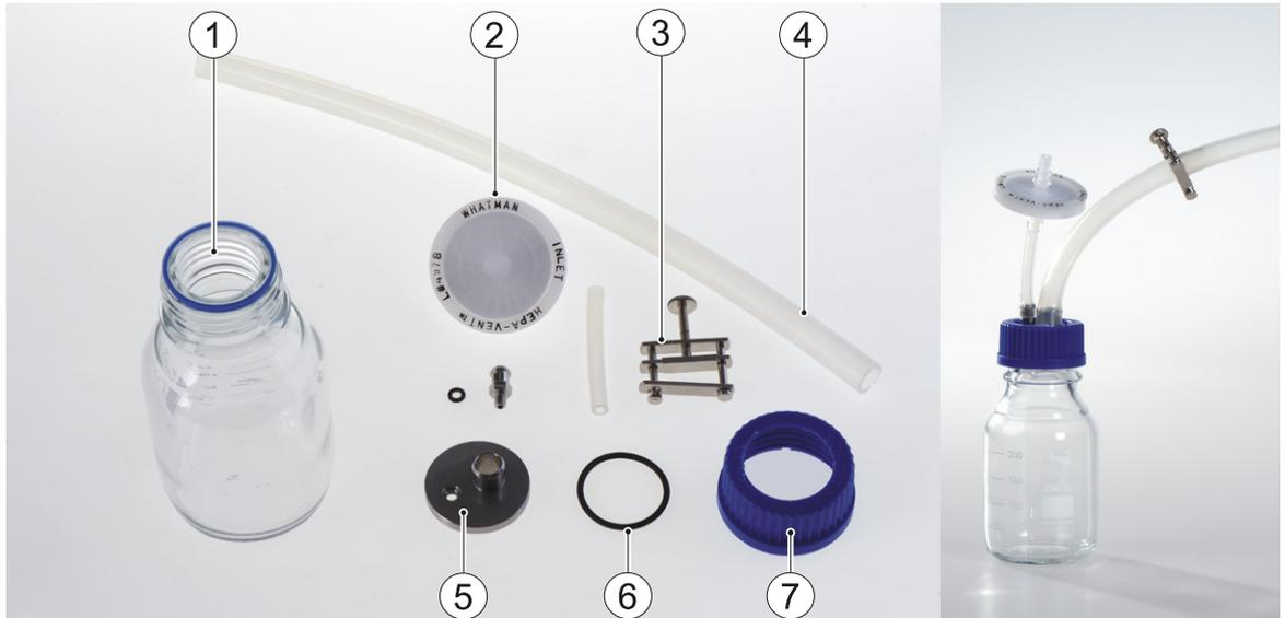
**Abbildung 5-15:** Kugelernteflasche für steriles Ernten und sterilen Transport der erzeugten Kugeln und Kapseln. Die Kugelernteflasche ist am Ernteventil des Reaktionsgefäßes befestigt.
