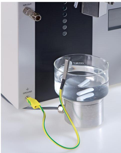
**Figura 6-4:** Toma a tierra del baño de polimerización
