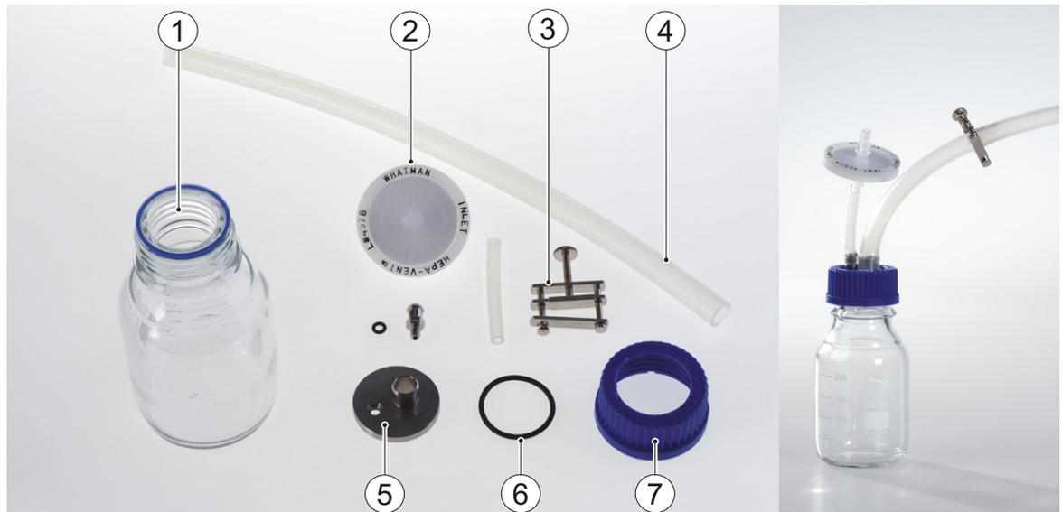
**Figura 5-15:** Frasco colector de perlas para recoger y transportar en condiciones estériles las perlas y cápsulas producidas. El frasco colector de perlas se acopla a la válvula colectora de perlas del recipiente de reacción.
