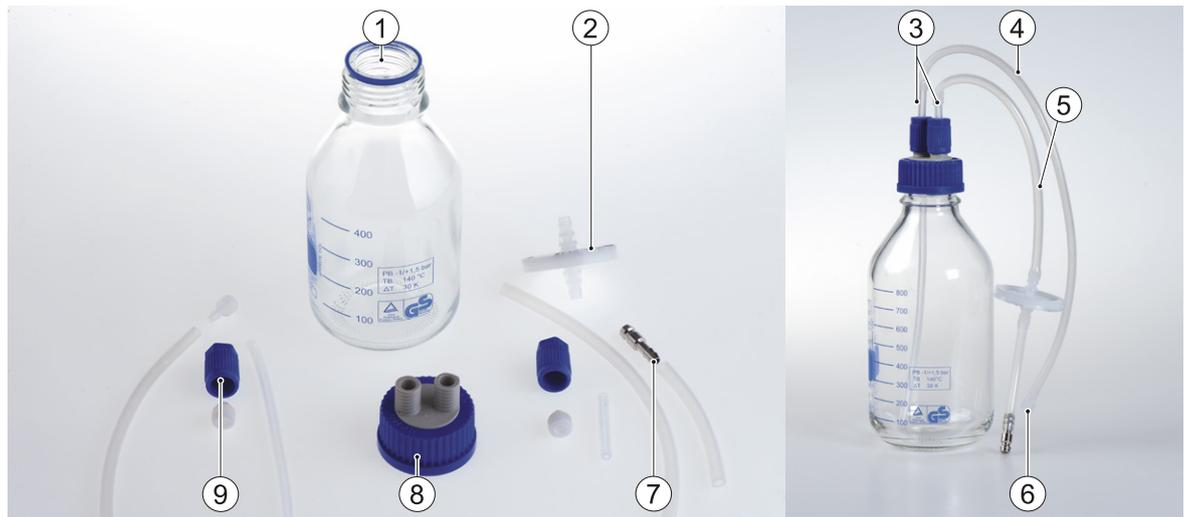
**Figura 5-17:** Botella de presión con filtro HEPA para bombeo estéril de la mezcla de inmovilización con presión de aire
