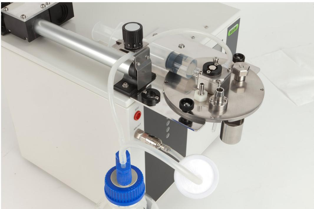
**Figura 5-25:** Instalación del sistema de CN con una bomba con jeringa y una botella de presión
