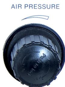
**Figura 6-2:** Sistema de regulación de la presión de aire para el control manual de la presión del aire – al girar la válvula de regulación de la presión en el sentido de las agujas del reloj, **aumenta** la presión.
