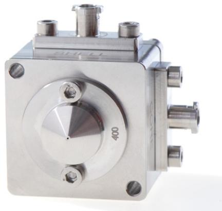
Ponga cuidadosamente la boquilla de cobertura sobre la boquilla interna. Acople la boquilla de cobertura con dos tornillos (M3×6). La boquilla de cobertura centra y fija la boquilla interna.
