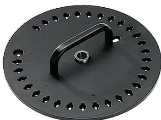
En el muestreador se puede alojar un máximo de treinta muestras con un diámetro máximo de 4 a 12 mm.
