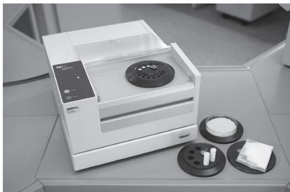
El NIRFlex Solids es la configuración ideal para medir muestras sólidas como polvos, pastas y granulados en el modo de reflexión difusa. La célula de medición para sólidos permite usar accesorios diferentes para contenedores de muestras específicos.
