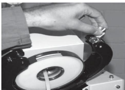
Illustration 4.14: Réglage de la tension de fermeture
