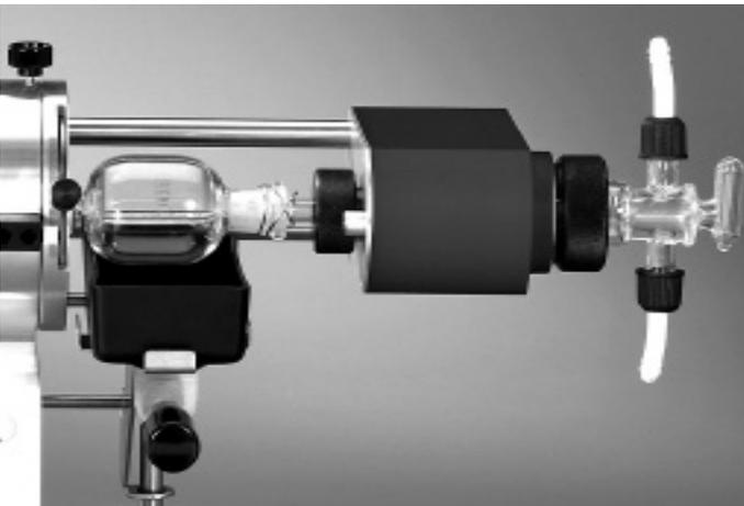
Figura 2: Accionamiento del tubo de bolas, completo
