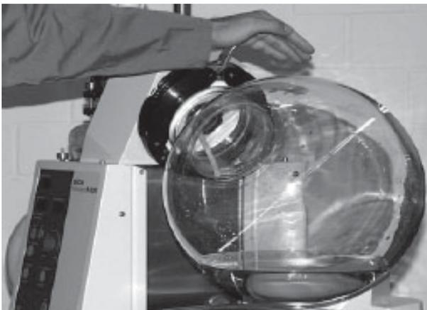
Bild 4.13: Kolbenhalsverbindung schliessen
