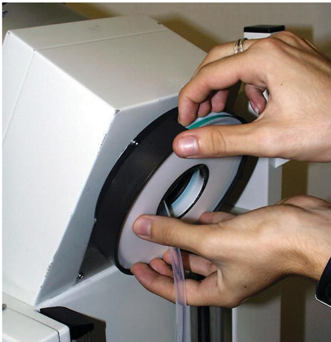
Bild 6.3: Verdampferkolbendichtung entfernen
