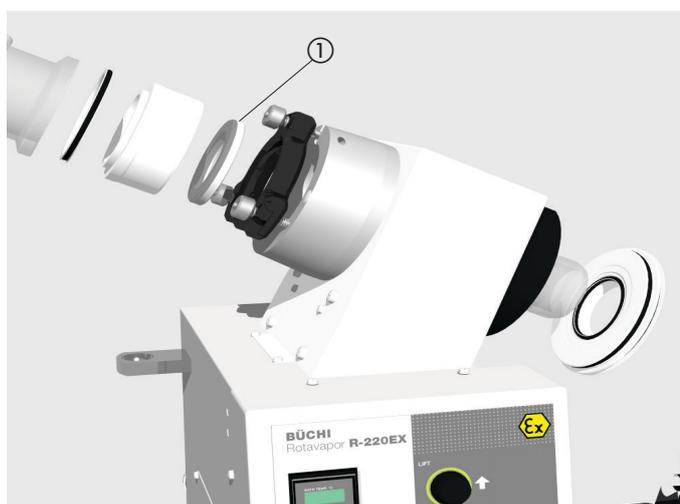
Bild 6.6: Auswechseln der Dichtungen zum Verteilstück
