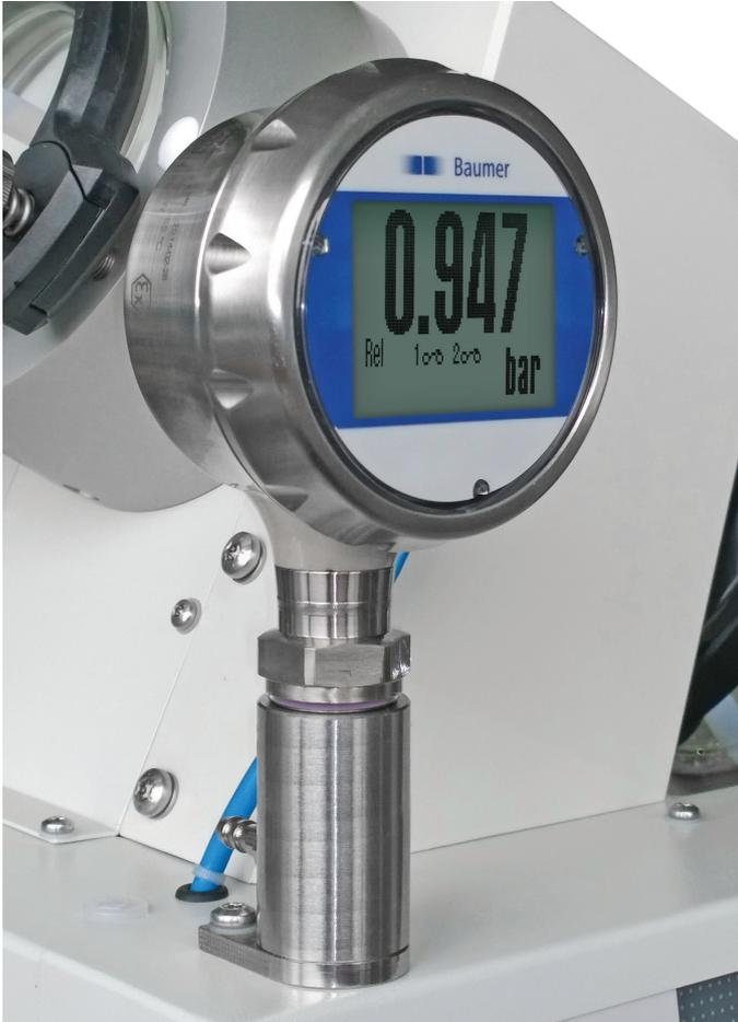
Bild 5.3: Vakuumkontroller
