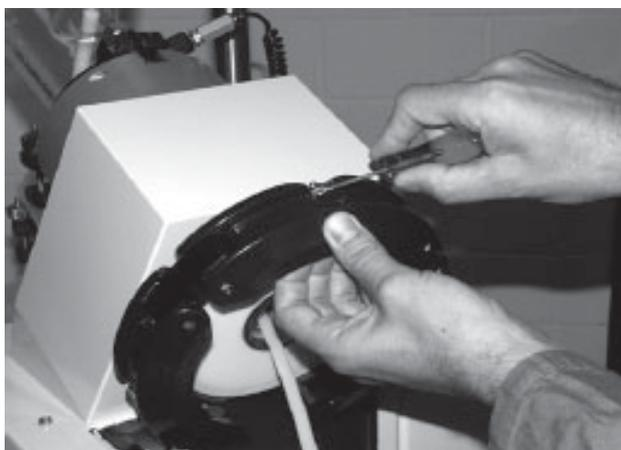
Bild 6.1: Kolbenhalsverbindung geschlossen
