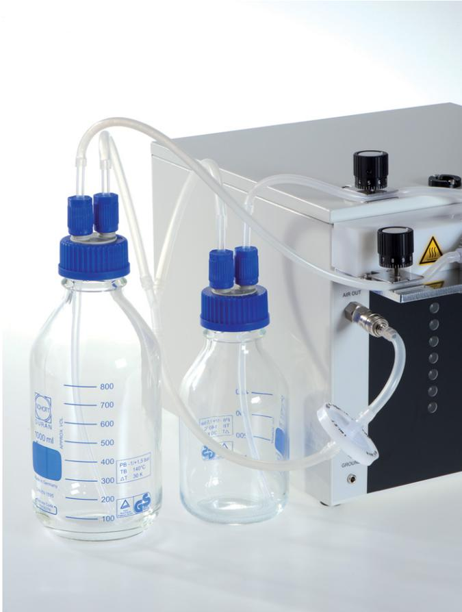
**Abbildung 5-18:** Verbindung der Druckflaschen mit dem Luftauslass. Über ein T-Stück werden beide Druckflaschen versorgt.
