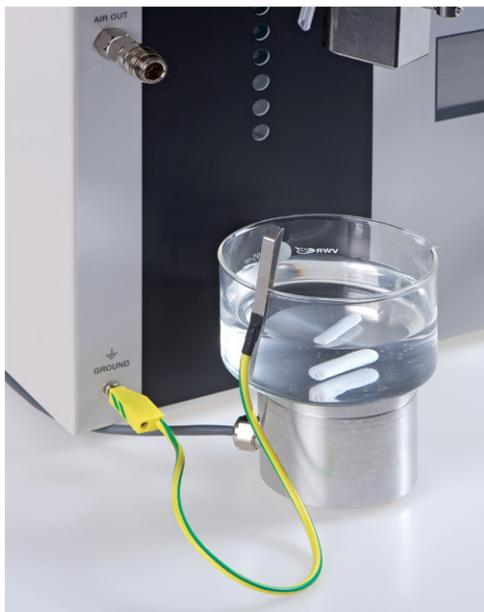
**Abbildung 6-3:** Erdung des offenen Polymerisationsbades
