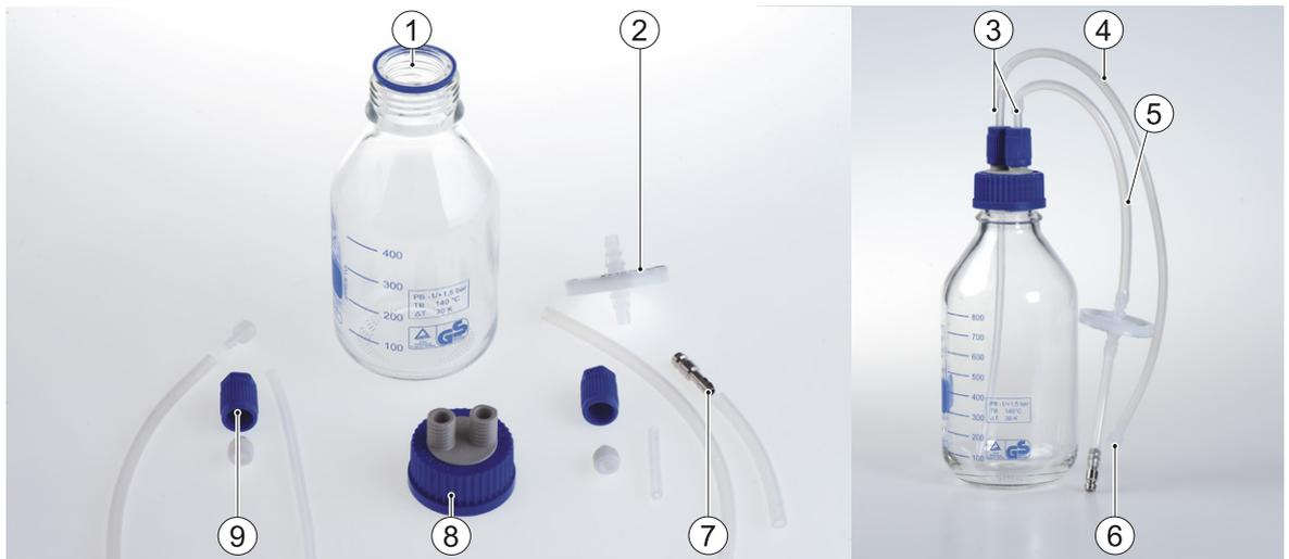
**Abbildung 5-9:** Druckflasche mit HEPA-Filter für steriles Pumpen der Immobilisierungsmischung mittels Luftdruck
