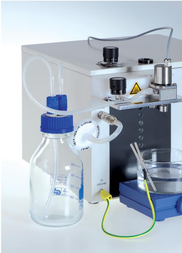
Abbildung 5-10: Installierte Druckflasche
