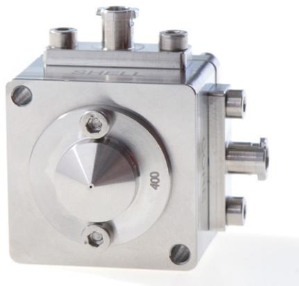
Die Manteldüse vorsichtig über die innere Düse setzen. Die Manteldüse mit zwei Schrauben (M3×6) befestigen. Die Manteldüse zentriert und fixiert die innere Düse.
