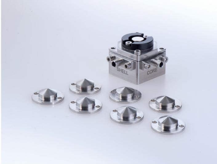
**Abbildung 5-13:** CN-Kugelerzeugungseinheit mit einem Satz von 7 Manteldüsen. Standarddurchmesser der Düsenöffnungen: 0,20, 0,30, 0,40, 0,50, 0,60, 0,70 und 0,90 mm.
