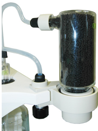
Abb. 5.16: Adsorptionsgefäß mit Aktivkohle und Glaswolle
