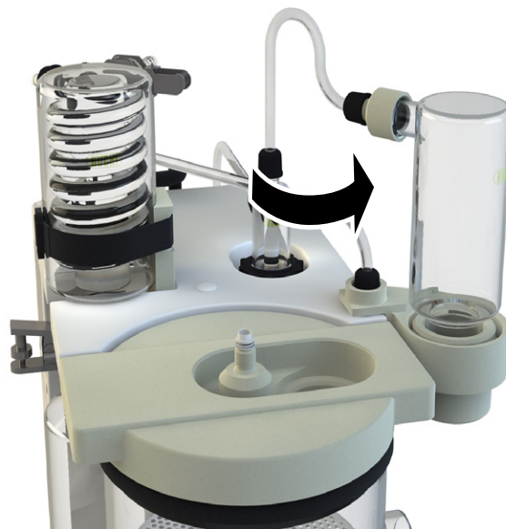
Abb. 5.4: Schwenken des Adsorptionsgefäßes und des Schlauchanschlusses zur Ablage
