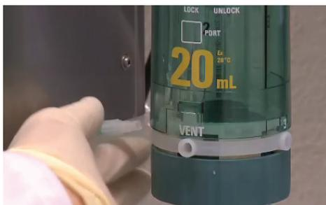
Abb. 5.8: Anschluss des FEP Schlauches an der Dosiereinheit
