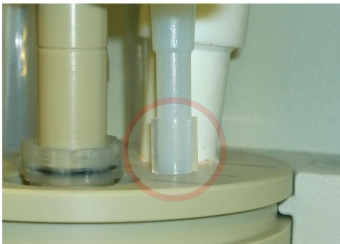
Abb. 5.12: Anbringung des Abstandhalters an der Dosierspitze
