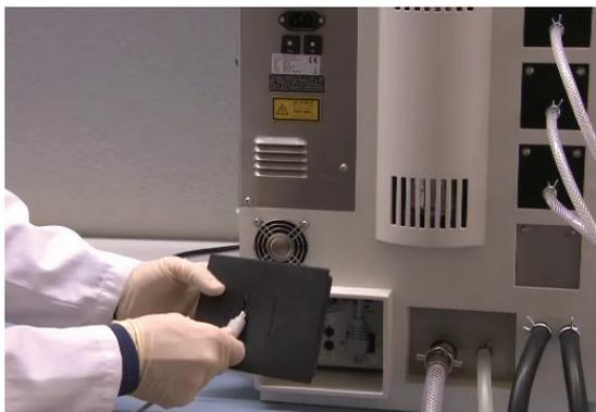
Abb. 5.10: Führung des Kabels durch den Ausschnitt
