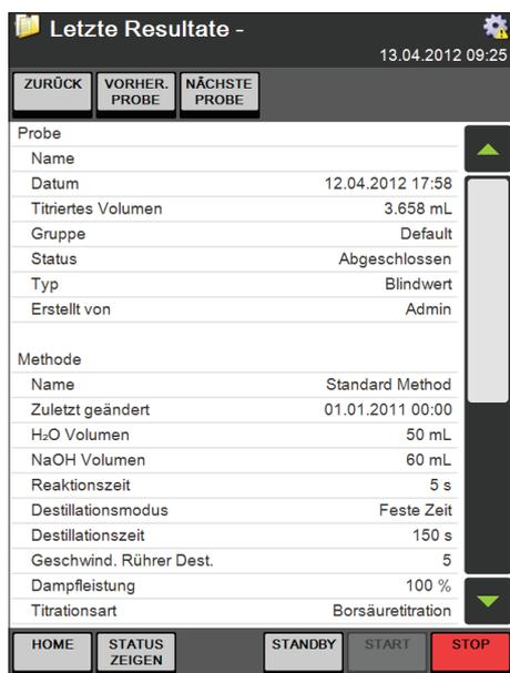
Mit **VORHER. PROBE** und **NÄCHSTE PROBE** können Sie zwischen den Berichten der gespeicherten Proben wechseln.
