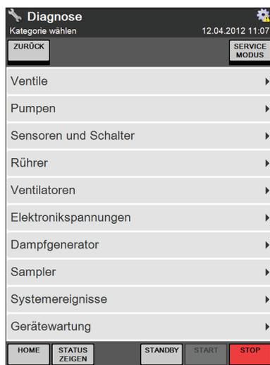
Über die Systemdiagnose kann der Status aller Systemkomponenten, wie Ventilen, Pumpen, Sensoren und Schaltern oder Lüftern, geprüft werden.
