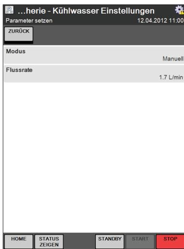
Ist ein Umlaufkühler ans Gerät angeschlossen, wird die Kühlwassersteuerung nicht angezeigt.
