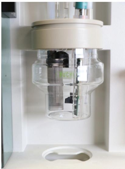
Abb. 5.17: Montieren des Schutznetzes am Sensor
