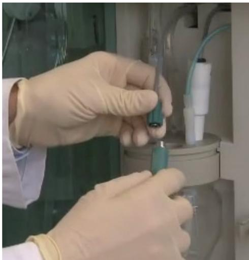
Abb. 5.16: Anschluss des Sensors
