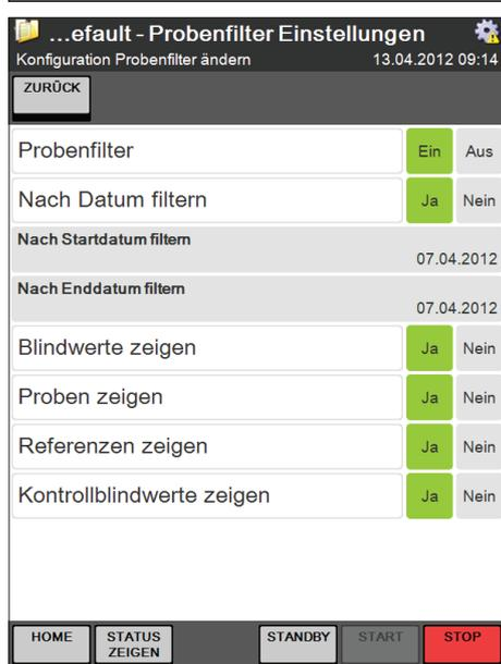
Den „Probenfilter“ auf **Ein** stellen, um die Liste der angezeigten Resultate zu filtern. **Ja** für „Nach Datum filtern“ wählen, wenn die Liste nach Erstellungsdatum gefiltert und ein Zeitraum mit Start- und Enddatum angegeben werden soll.
