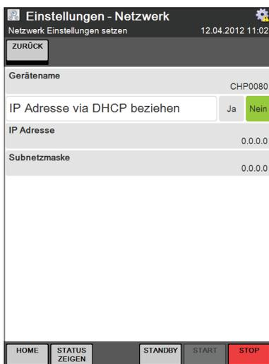
Bei einer Netzwerkanbindung können Sie dem Gerät zur Identifizierung innerhalb des Netzwerks einen Gerätenamen zuweisen. Die IP-Adresse kann entweder automatisch via DHCP (**JA** auswählen) bezogen oder manuell zusammen mit der Subnetzmaske eingegeben werden.
