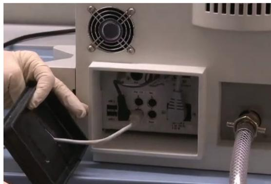
Abb. 5.11: Anschluss des Antriebsmotor Kabels
