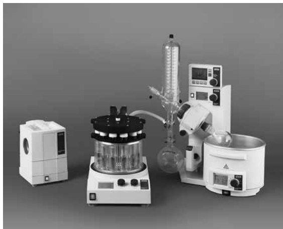
Fig. 4.19: Condivisione delle risorse tra condensatore, pompa da vuoto e controllore di vuoto con Rotavapor e Multivapor
