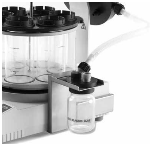
Fig. 4.17: Bottiglia di Woulff installata
