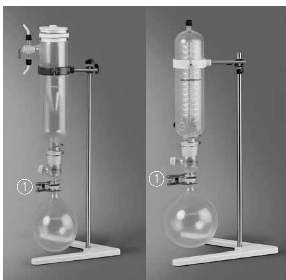
Fig. 5.24: Installazione del gruppo di condensazione sul supporto
