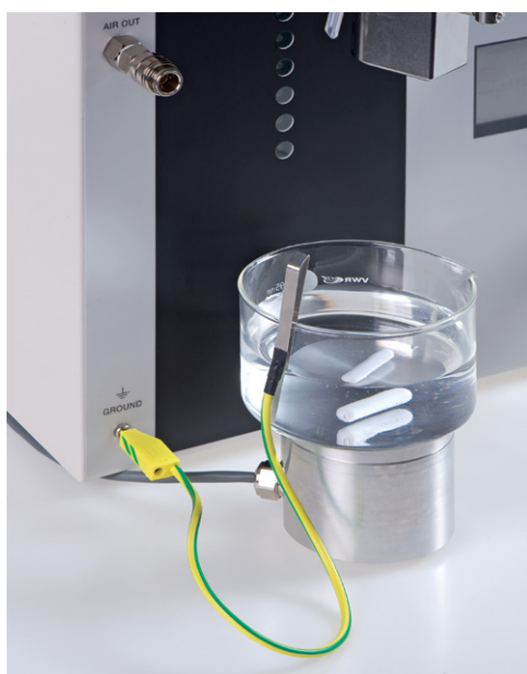
図 6-3：開放型重合反応槽の接地方法
