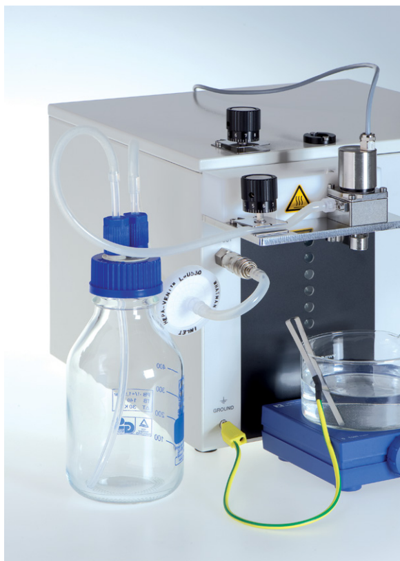
図 5-10：設置された圧力ビン
