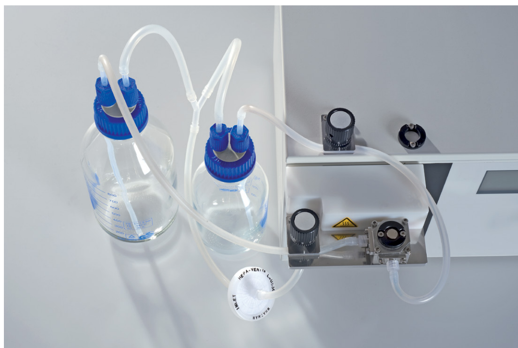
図 5-17：同心ノズルシステムの設置
