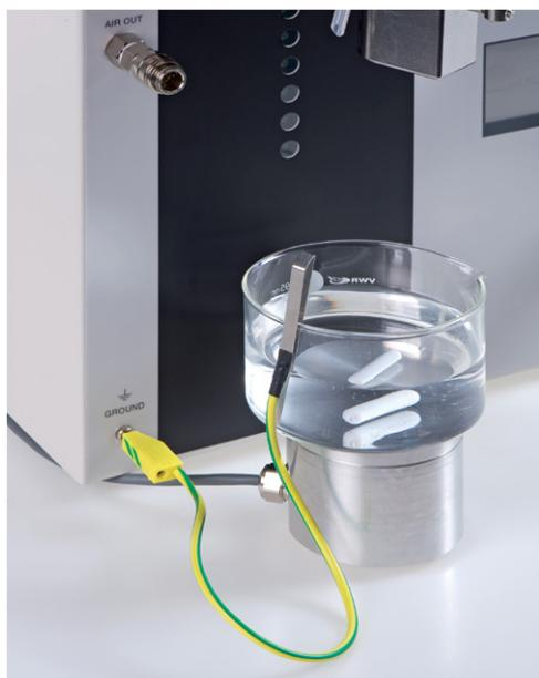
**Figura 6-3:** Toma a tierra del baño de polimerización abierto
