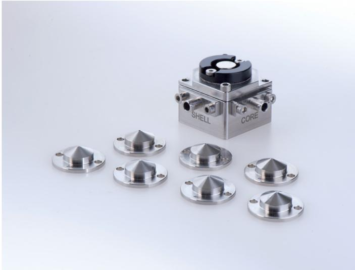
**Figura 5-13:** Unidad de producción de perlas de CN con conjunto de 7 boquillas de cobertura. Las siguientes aperturas de las boquillas son estándar: 0,20, 0,30, 0,4, 0,50, 0,60, 0,70 y 0,90 mm.
