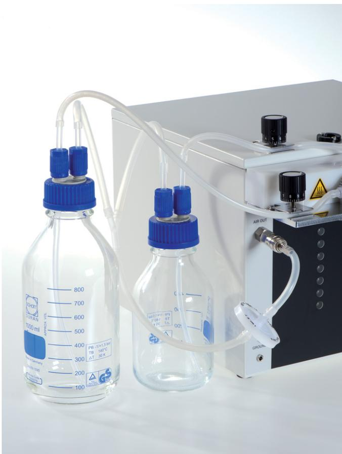
**Figura 5-18:** Conexión de las botellas de presión a la salida de aire. Una pieza en T alimenta ambas botellas de presión.
