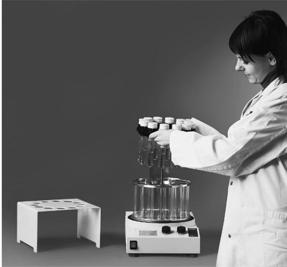
Fig. 4.13: Transferencia simultánea de muestras usando la placa de transferencia
