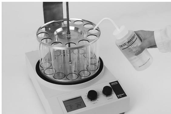
A cada cilindro se añade agua destilada en el rack de cristal para transferir el calor de la placa calefactora al tubo de muestra. Hay que añadir la misma cantidad de agua a cada cilindro para proporcionar una transferencia uniforme del calor. La indicación de nivel designa los volúmenes óptimos dependiendo del tipo de tubo de muestra.
