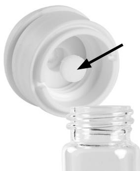
Para retirar las fritas opcionales de polietileno del adaptador de tubo, presione un objeto fino desde la parte superior por el orificio.
