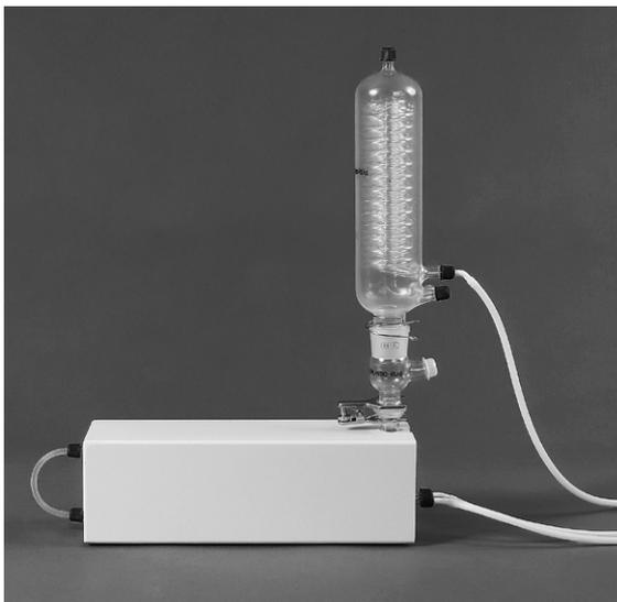
Fig. 4.20: Receptor refrigerado con condensador de tipo S
