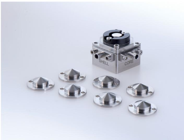
**Figura 5-21:** Unità di produzione di beads con sistema CN con set di 7 ugelli esterni. Gli ugelli sono disponibili con i seguenti fori standard: 0,20/0,30/0,40/0,50/0,60/0,70 e 0,90 mm.
