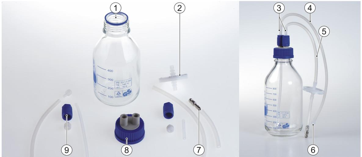
**Figura 5-17:** Bottiglia a pressione con filtro HEPA per pompaggio sterile della miscela di immobilizzazione tramite aria compressa
