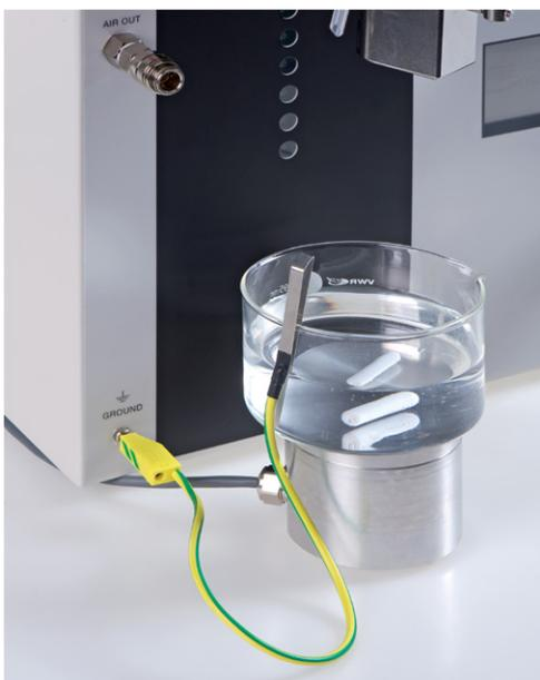
**Figura 6-4:** Collegamento a terra del bagno di polimerizzazione aperto
