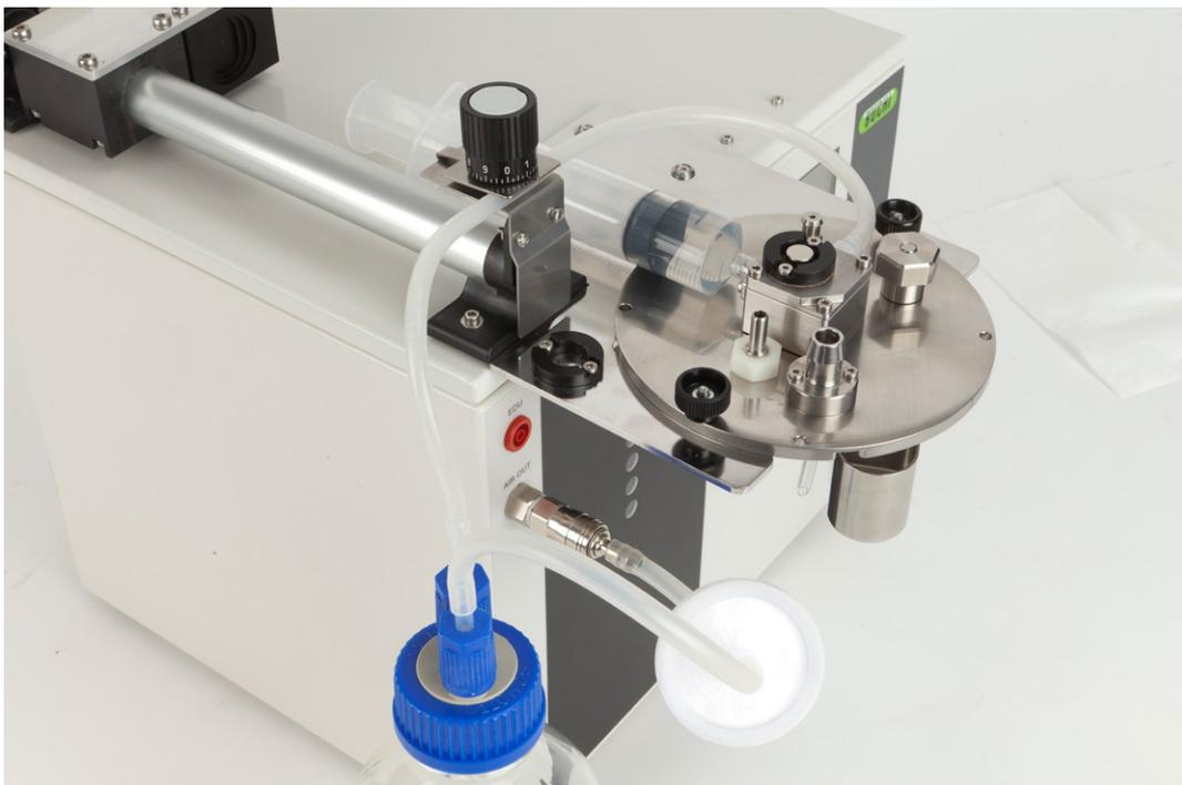
**Figura 5-25:** Installazione del sistema CN con una pompa per siringa e una bottiglia a pressione
