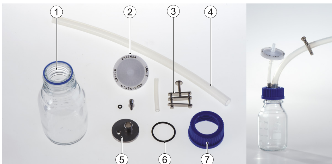
図 5-15： 作成したカプセル球を無菌状態のまま採取、移動するためのカプセル球収集フラスコ。 カプセル球収集フラスコは反応槽のカプセル球採取弁に接続します。
