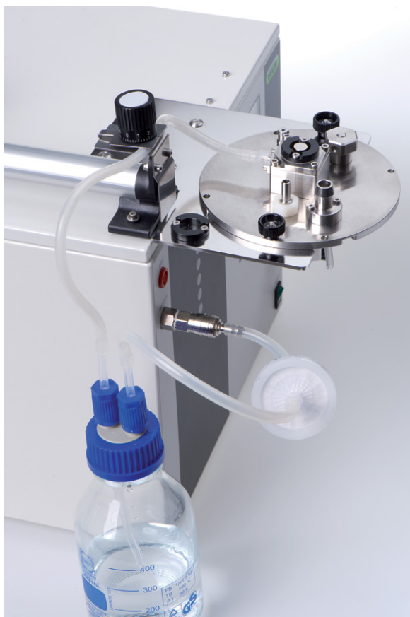
図 5-18：設置された圧力ビン
