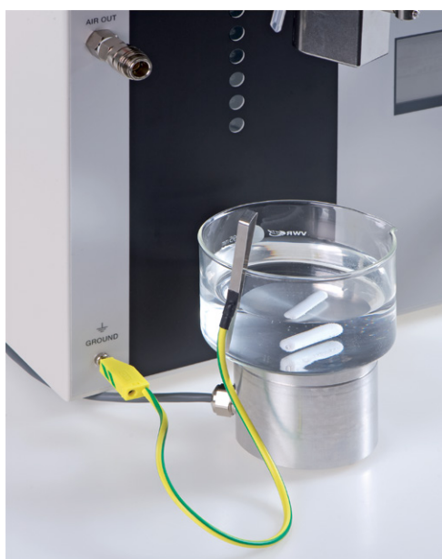
図 6-4：開放型重合反応槽の接地方法
