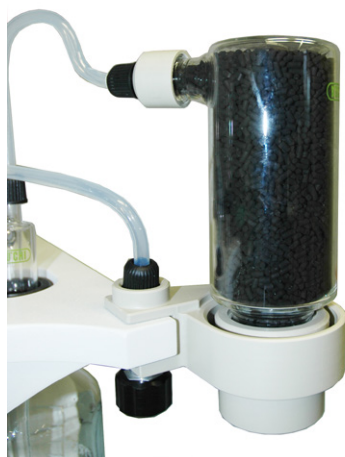
Fig. 5.16 : Vase d'adsorption avec charbon actif et laine de verre
