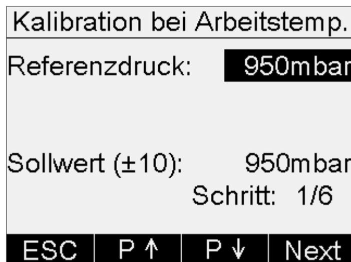
Abb. 18: Menü > Kalibration Drucksensor > Kalibration Druck einfach
