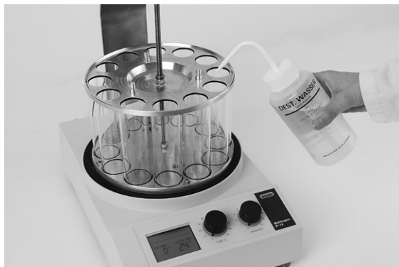
Fig. 6.30: Einfüllen von destilliertem Wasser bis zu einem Füllstand, bei dem während des Betriebs eine starke Durchmischung erzielt wird
