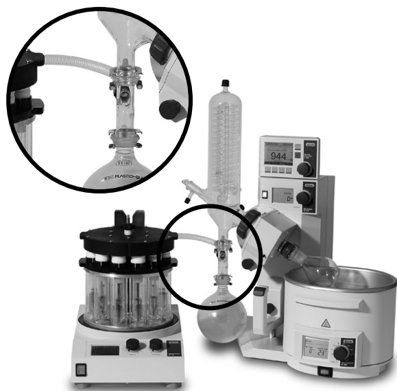
Fig. 5.28: Inbetriebnahme der Multivapor-Rotavapor-Ausführung
