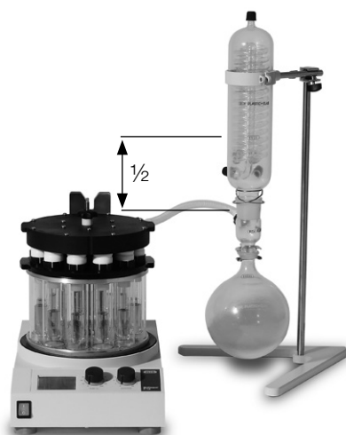
Fig. 6.36: Optimale Befüllung des Kühlers
