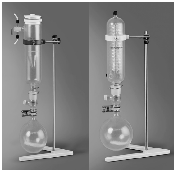
Fig. 4.16: Typ C (links) und Typ S (rechts) Kühleraufbauten
