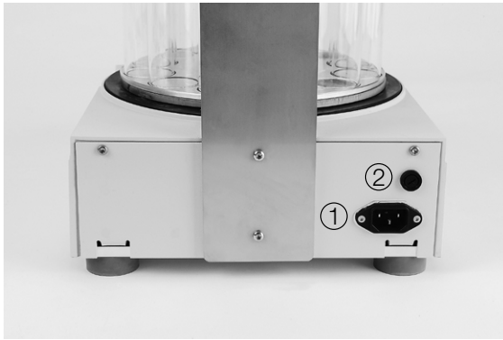
Fig. 4.6: Anschlüsse an der Rückseite des Multivapor
