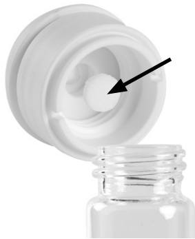
Fig. 7.44: Entfernen der PE-Fritten
