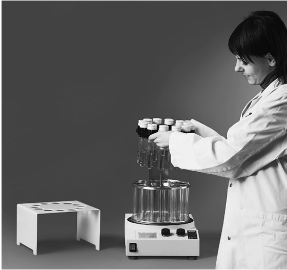
Fig. 4.13: Probentransfer mit der Transferplatte
