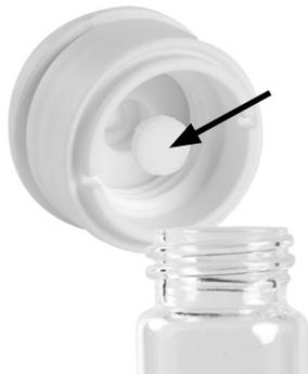
Pour enlever les frittés PE optionnels de l'adaptateur de tube, pousser un objet fin par le haut à travers l'orifice.
