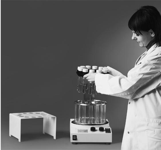
Fig. 4.13 : Transfert d'échantillons simultané au moyen de la plaque de transfert
