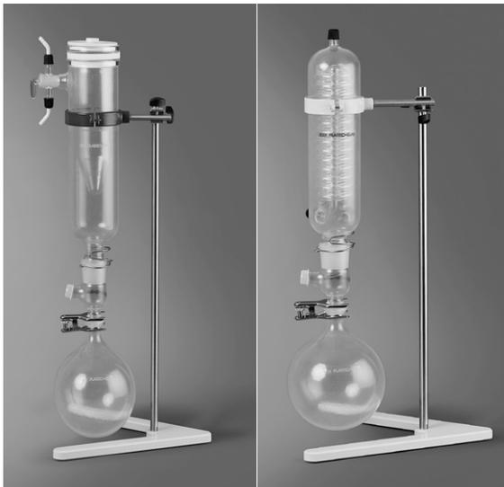
Fig. 4.16 : Assemblages réfrigérant de type C (à gauche) et de type S (à droite)
