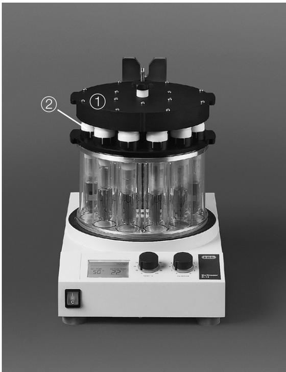
Fig. 4.14 : Multivapor avec crystal rack et prise de vide correspondante
