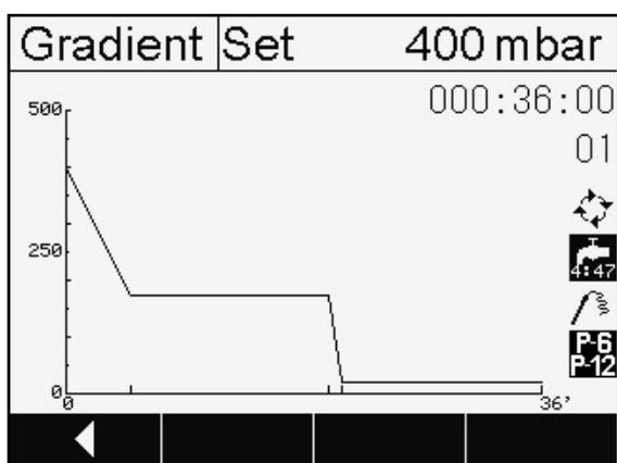
Fig. 6.34 : Exemple de réglage de gradient avec une étape de séchage consécutive à l'évaporation de solvant
