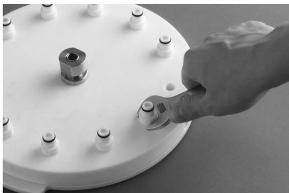
Fig. 5.29 : Serrage des contre-écrous des adaptateurs coniques
