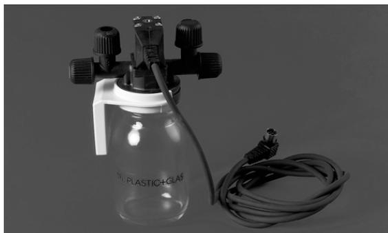
Unité de soupapes pour régulateur de vide V-850 / V-855 combiné avec des pompes à vide d'autres marques
