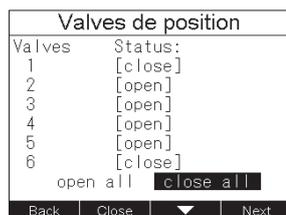
Appuyer sur NEXT (SUIVANT) pour ouvrir le sous-menu POSITION VALVES (VANNES DE POSITION). L'état des six (E-916) ou quatre (E-914) vannes de position est indiqué et peut être modifié individuellement OPEN (OUVRIR) CLOSE (FERMER) ou globalement OPEN ALL (OUVRIR TOUT) CLOSE ALL (FERMER TOUT).
