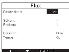
Sélectionner SERVICE FONCTIONS (FONCTIONS D'ENTRETIEN) → FLOW (DÉBIT). Définir les paramètres avec le bouton de sélection. Appuyer sur START (DÉMARRER) pour commencer le test de débit.
