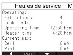
Sélectionner SERVICE FUNCTIONS (FONCTIONS D'ENTRETIEN) → OPERATING HOURS (HEURES DE SERVICE). Le nombre d'extractions et de tests de fuites ainsi que les heures de service de l'instrument et du chauffage sont indiqués. Elle affiche aussi des données comme la température ou la pression maximales atteintes. Ces informations sont particulièrement importantes pour le technicien de maintenance. Retourner à SERVICE FUNCTIONS (FONCTIONS D'ENTRETIEN) avec la flèche gauche.
