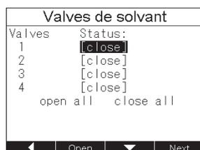
Sélectionner SERVICE FONCTIONS (FONCTIONS D'ENTRETIEN) → VALVES (VANNES). Selon le type de mélangeur, 2 ou 4 vannes de solvant et leur état respectif sont affichés. Appuyer sur OPEN (OUVRIR) ou CLOSE (FERMER) pour changer l'état des vannes ou sur OPEN ALL (OUVRIR TOUT) ou CLOSE ALL (FERMER TOUT) pour appliquer l'action à toutes les vannes. Les vannes de solvant sont des vannes magnétiques. Un clic audible se produit lors de la commutation des vannes.
