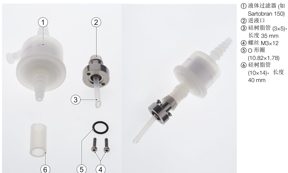
图 5-11: 液体过滤器 – 分解图 (左图), 组装后视图 (右图)
