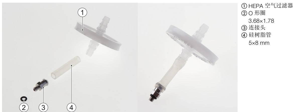
图 5-10: 空气过滤器 – 分解图 (左图), 组装后视图 (右图)
