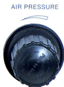
图 6-2: 用于手动气压控制的气压调节系统 – 顺时针转动压力调节阀增加压力。
