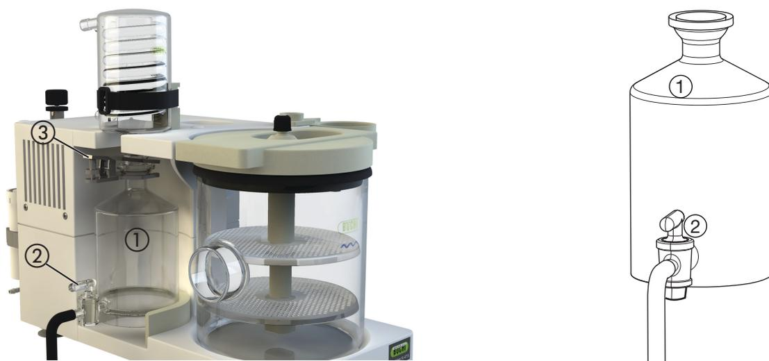
图5.9：TKN装置的连接
