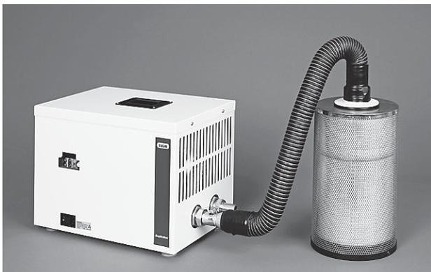
L'aspirateur fonctionne comme une pompe destinée à établir un flux de gaz constant. Il présente des dimensions compactes de 47,5×30×32 cm et peut être placé à côté du Nano atomiseur B-90 HP Advanced ou sur le plateau d'une table de conduite.
