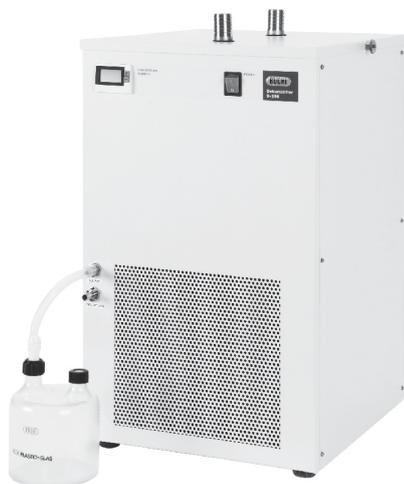
Le Déshumidificateur B-296 Nano est un accessoire qui peut sécher des gaz dans des conditions d'humidité constantes et reproductibles avec un point de rosée de 3 à 5 °C. L'humidité se condense lors de son passage dans le réfrigérateur du Déshumidificateur B-296 Nano et est collectée dans une bouteille de condensat fermée.
