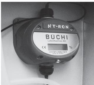
La sonde d'oxygène équipe les modèles avancés. Elle s'utilise pour surveiller le taux d'oxygène dans le gaz de séchage en mode boucle fermée.
