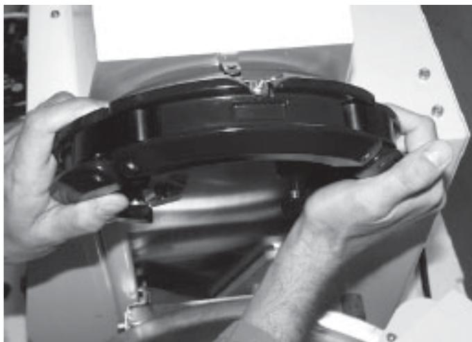
Figura 6.2: Montaje de la unión de cuello de matraz
