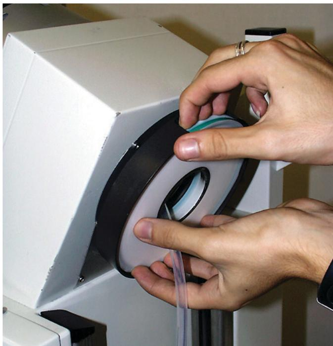
Figura 6.3: Quitar la junta de matraz de evaporación
