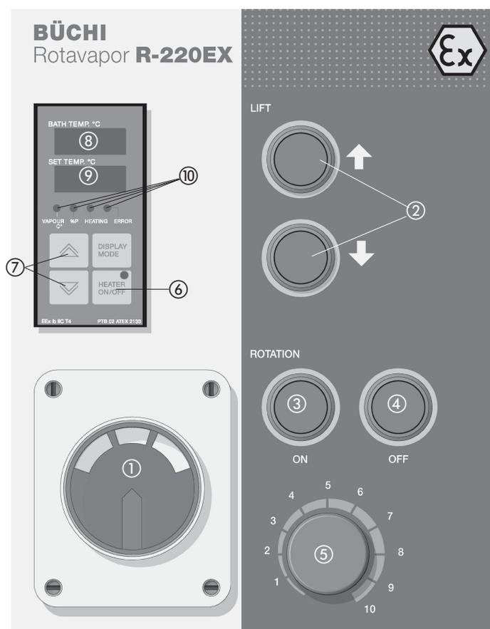
Figura 5.1: Disposición de los indicadores y elementos de mando
