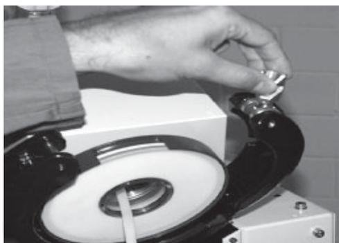
Figura 4.14: Ajuste de la tensión de cierre
