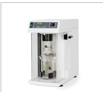
O Mixer B-400 combina a eficiência ideal com a facilidade de operação e flexibilidade quando é necessária a homogeneização de amostras.
