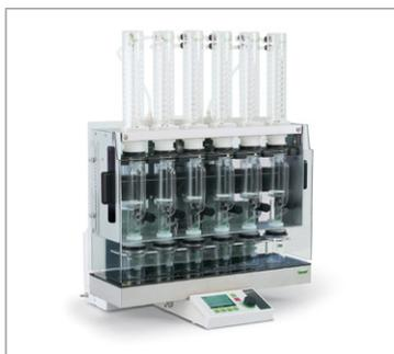
Estrazione dei grassi totali pienamente conforme alle normative AOAC con le Unità di estrazione E-812 e E-816.
