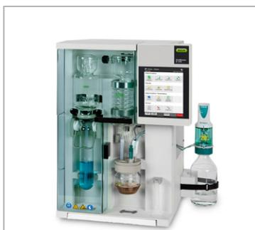
Le KjelMaster K-375 constitue la technologie de référence idéale pour étalonner les spectromètres NIR pour la détermination des protéines.
