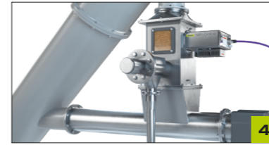
4 干燥 控制水分含量，调节干燥程度。
