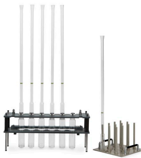
Demanda química de oxígeno (mediante condensadores de reflujo de aire)
