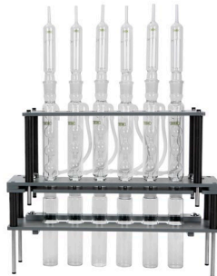
Trazas de metales e hidroxiprolina (mediante condensadores de reflujo de agua)
