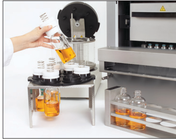
การถ่ายโอนตัวอย่างจาก SpeedExtractor ไปยัง Multivapor™
