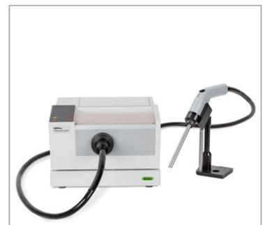
Nahinfrarot-Spektroskopie ist die bevorzugte Technologie zur Ergänzung der klassischen Fettbestimmung durch eine schnelle Prüfmethode.
