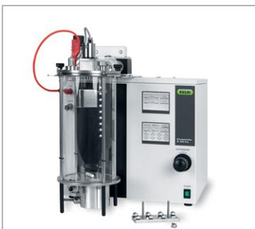
Verkapseln Sie mit Hilfe des Encapsulator B-390 oder B-395 Pro Ihre Wirkstoffe in einer Matrix, um sie zu schützen oder kontrolliert freizusetzen.
