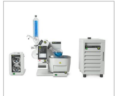
Der Rotavapor® R-300 ist ein Rotationsverdampfer für anspruchsvolle Verdampfungen zur sicheren Verdampfung mit bis zu 5-Liter-Kolbenvolumen.
