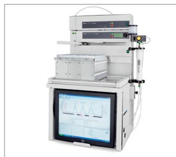
Le système flexible Sepacore® pour la purification flash simple ou les solutions complètes de chromatographie automatisée.
