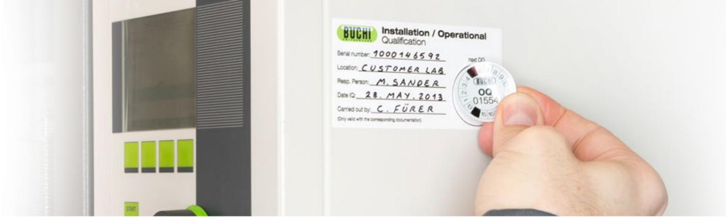
La cualificación de la instalación «IQ» ofrece una prueba documentada de que el equipo se ha entregado y se ha instalado de acuerdo con los requisitos y la normativa de seguridad establecida por ley estipulados en la cualificación de diseño. Después de realizar con éxito una cualificación de la instalación «IQ», las personas responsables permiten que el equipo pase a la siguiente fase de la cualificación, que normalmente se trata de la cualificación operativa «OQ».
