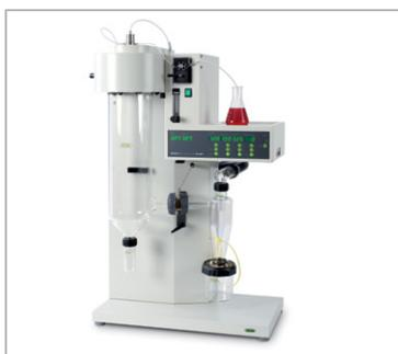
Mini Spray Dryer B-290 (ミニスプレードライヤー) は、穏和な条件下で迅速に溶液を乾燥して粉末化するのに理想的な装置です。
