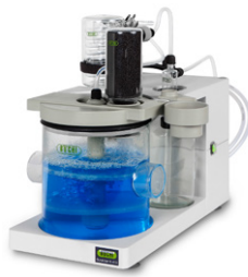
Scrubber K-415 중화
